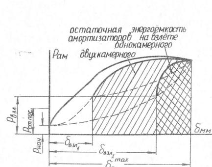
Рис. 2.10. Сравнительные диаграммы работы однокамерного и двухкамерного амортизаторов
